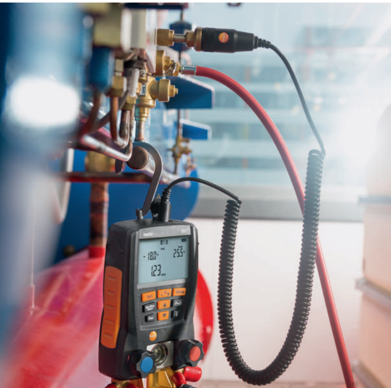
Zeer nauwkeurige vacuüm meting: testo 557 met externe sonde
